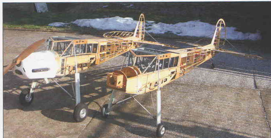
Čáp a Storch - kostry trupů obou provedení modelů
