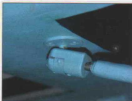
Detail uchycení vzpěry kulovým kloubem ke křídlu - možnost délkového nastavení pomocí závitu
