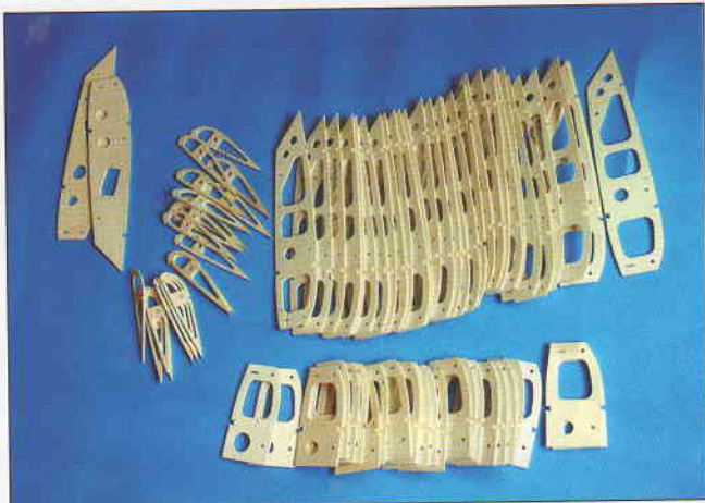
Vyřezaná žebra a položebra pro křídla (topolová překližka z banánových krabic)
