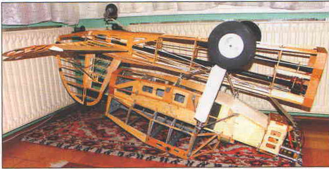
Šachy s dělením a skládáním trupu, aby se vešel do kufru Yarise
