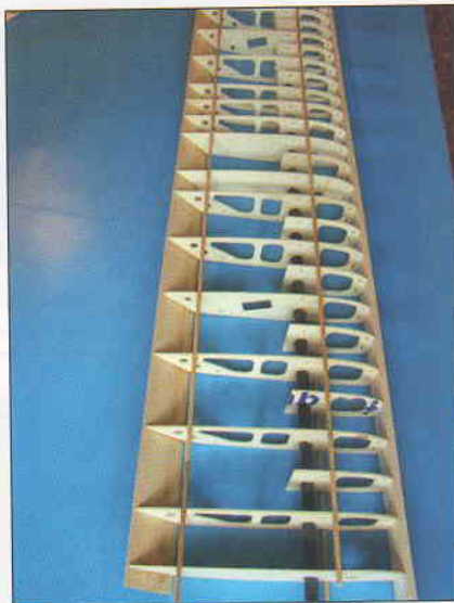
Kostra křídla s patrným hlavním uhlíkovým nosníkem a balzovým plátem, na kterém je uchycen polystyrenový protikus křidélek a klapek
