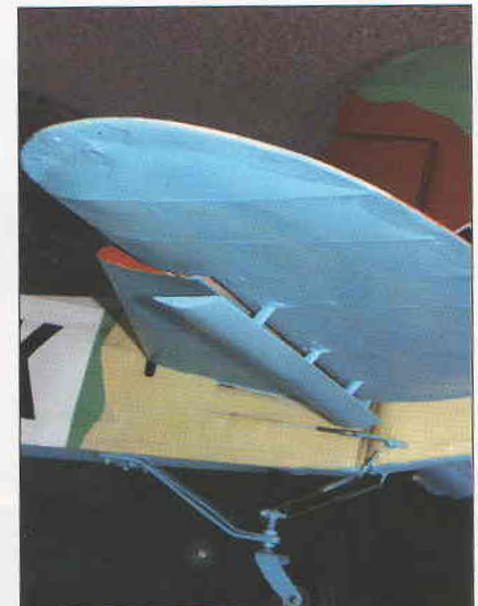
Dynamické odlehčení sil ve výškovce vyvažovací ploškou pod výškovkou (pouze u německých provedení)
