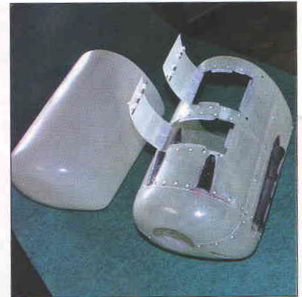
Úpravy motorového krytu - přístupové otvory, chlazení
